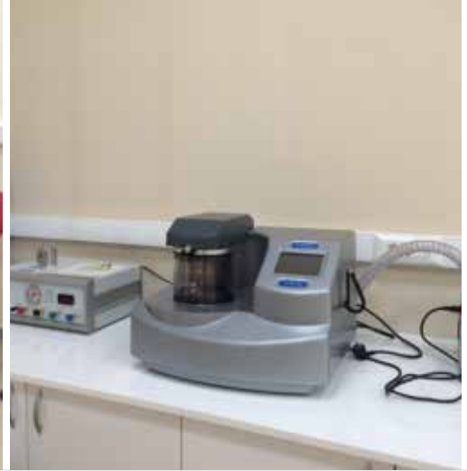
Kaplama (QUORUM Q150 RES) ve Kurutma cihazları
