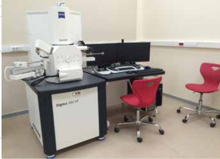
Carl Zeiss 300VP SEM Cihazı
